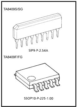
Weight SIP9-P-2.54A: 0.92 g (typ.) SSOP10-P-225-1.00: 0.09 g (typ.)
